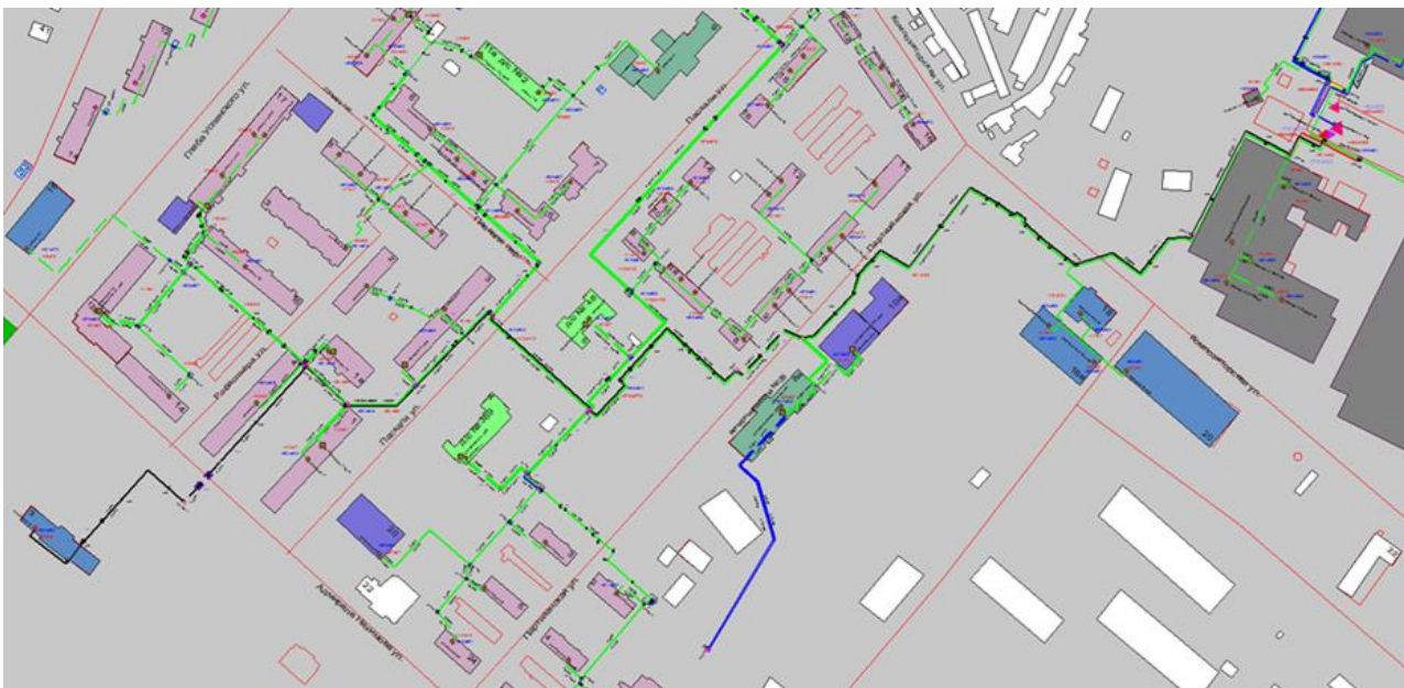
Рисунок 3.33 – Трассировка теплопровода от котельной АО «Теплоэнерго» по ул. Памирская, д. 11 до конечного потребителя «ПТ-Нахимов,3»
